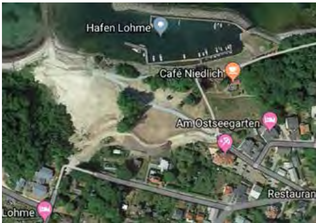
Abb. 8: Ausschnitt (Googlemaps) vom Hafen und Ortsteilen, Lohme auf Rügen. Die teilweise sanierten Rutschmassen sind südlich des Hafens, meist unbegrünt zu sehen.
