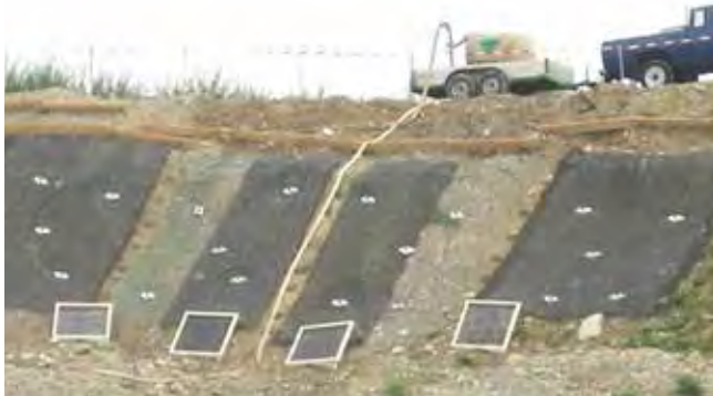
Abb. 5: Versuchsflächen und Versuchsrahmen zum Zeitpunkt der Aussaat.
