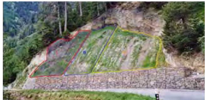
Abb. 4: Versuchsflächen zur Evaluation einer Erosionsschutzmatte.
