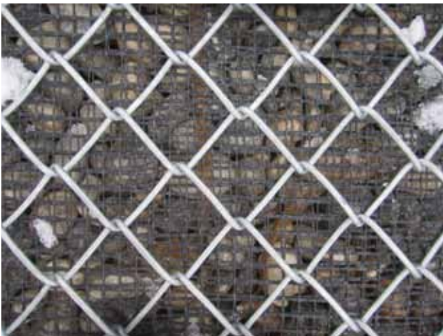
Bild 14: Test Nr. 8, Quadratmaschengeflecht 50 x 50 / 4.6 mm
