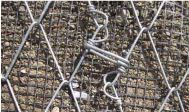
Bild 3: Versuch Nr. 5, TECCO® G65/3 + P33, sandiger Kies 0 - 63 mm, mit Verbindungsclips und unterlegtem Gewebe
