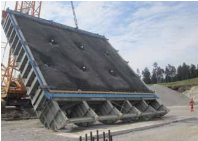
Bild 11: Test Nr. 11, TECCO® G65/3 + P33, Nagelraster 3.5 x 3.5 m, sandiger Kies 0 - 63 mm, \alpha = 53^\circ , erste oberflächennahe Rutschungen
