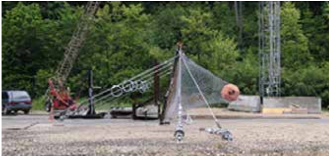
Abb. 9: Steinschlagtest in eine Hangmurenbarriere MEL 500 kJ gem. ETAG 027.
