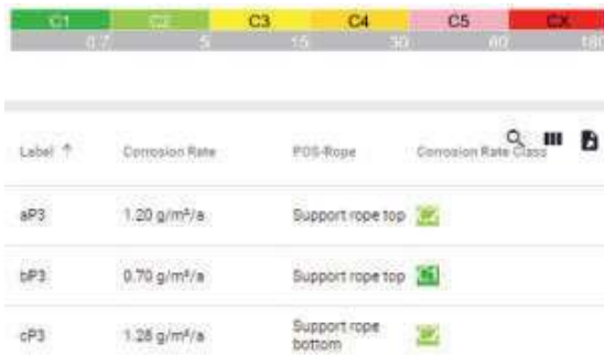
Abbildung 4: Ausschnitt aus dem GUARD Dashboard mit Angaben zur Korrosivität und Einordnung in die Korrosivitätsklassen in C1 bis CX.
