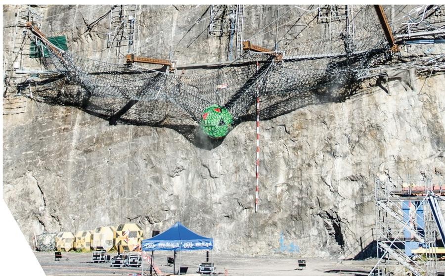
*Il sistema in un test 1:1: Il blocco di prova da 25 tonnellate viene lasciato cadere da un'altezza di 42 metri e fermato dalla barriera RXE.*
