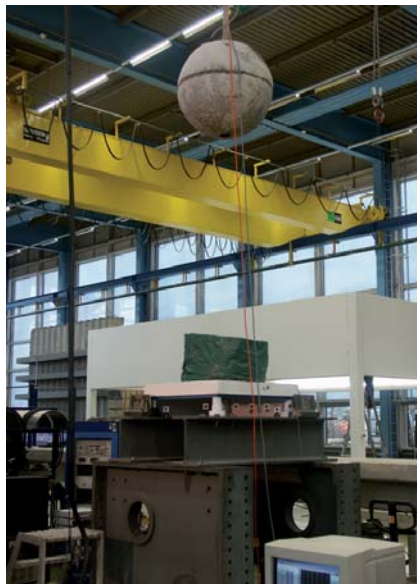
Abb. 6a & b: Laborversuch mit TECCO®-Zylindermodulen, Versuchsanordnung.
