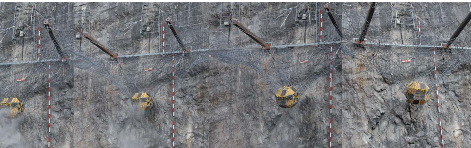
Imagen izquierda: los cables de soporte y de captura de rocas son conducidos prácticamente sin rozamientos a través de poleas
